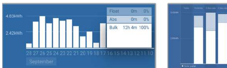
Sistema che rimane sempre in massa con interruzioni delle fasi di carica - Sistema in massa e assorbimento
