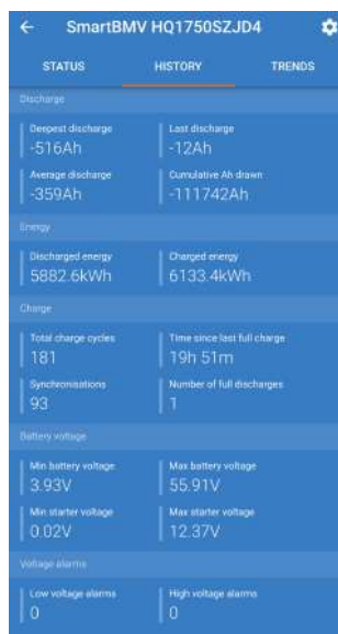
Visualizzazione della cronologia del monitor della batteria BMV nella app VictronConnect
