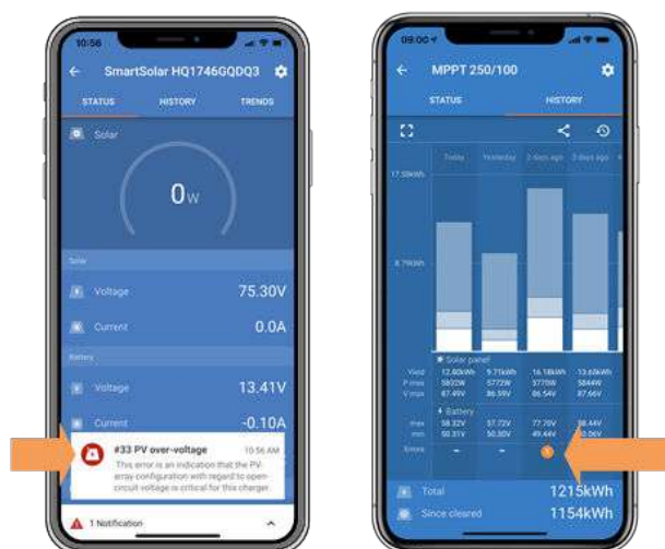
VictronConnect: schermata di un Errore #33 e schermata di una cronologia indicante un errore
