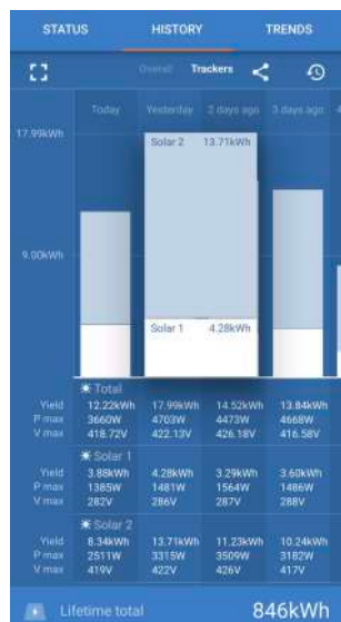
Figura 4. Vista dei tracciatori del MPPT
